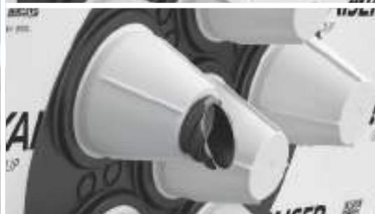
Gracias a su manguito de protección contra dobleces, los **manguitos de estanqueidad al aire múltiple ECON®** para cables y tubos garantizan un sellado fiable de uno a seis cables de hasta Ø 11 mm o de tubos de hasta Ø 25 mm. Se garantiza una estanqueidad permanente y fiable incluso cuando se produce un ángulo pronunciado en el nivel de instalación.
