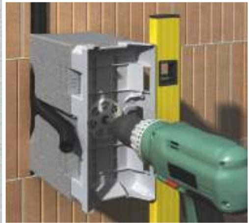
El **portaequipos del sistema con inserto de varias unidades** es adecuado para espesores de aislamiento de 160-310 mm. El diseño modular y la composición de los elementos individuales en tramos de 10 mm permiten una adaptación flexible al sistema de aislamiento.
